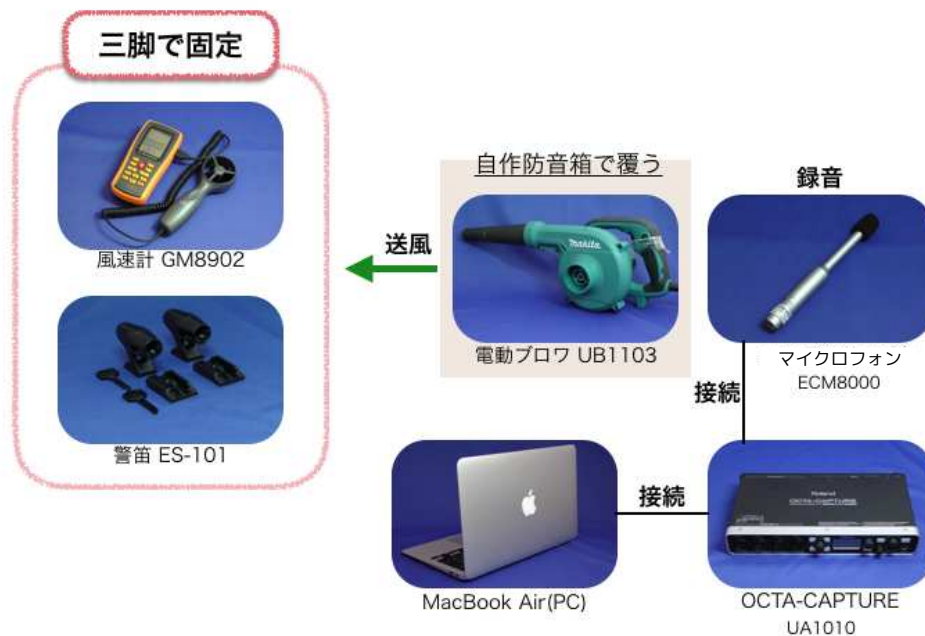
図 3.4: 実験器具配置図 (ブロワ使用時)
